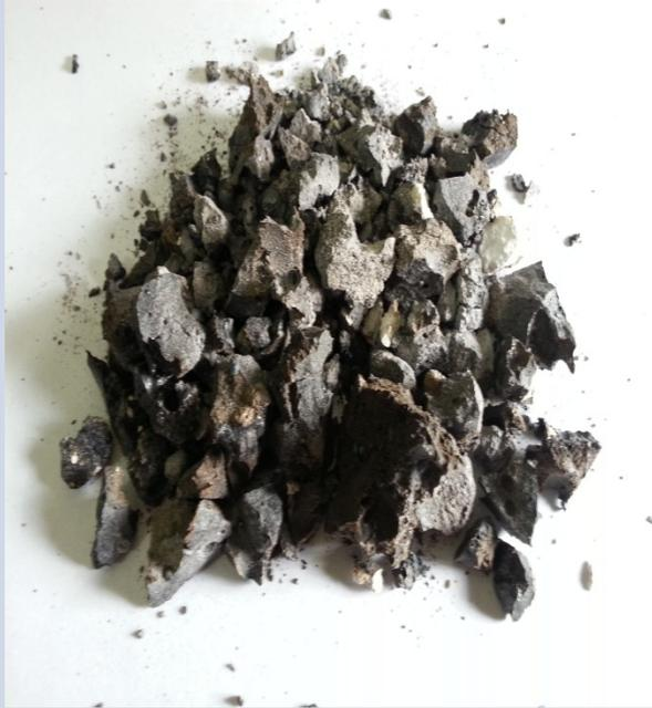
Escoria de afino (cuchara) se produce durante la fase de afino del baño fundido y presenta en su composición química silicatos cálcicos y bicálcicos además de aluminatos tricálcicos y ferritos dicálcicos
