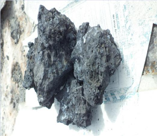
La escoria de horno fusión se produce durante una serie de fases como la oxidación para eliminar impurezas desfosforación y formación de escoria espumante donde se acumulan todas las impurezas al final de esta fase se obtiene la escoria horno fusión o escoria negra
